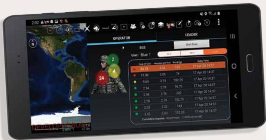
**Connectivité mobile** : L'application Blast Gauge System (BGSA) pour Android™ permet l'analyse et le téléchargement de données en quasi-temps réel avec Bluetooth 4.1
